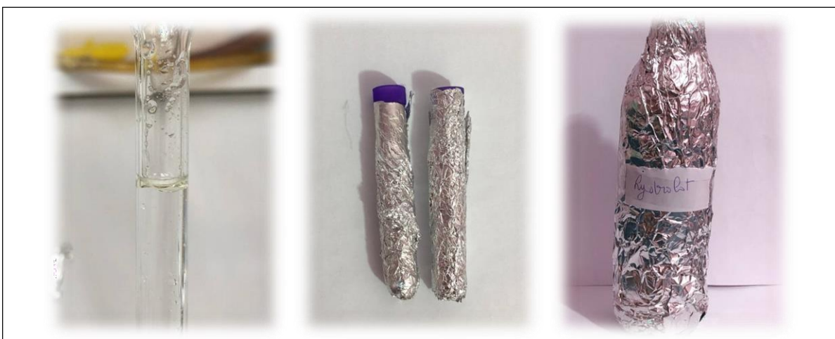
Figure 16 : Collecte, séparation et conditionnement de l'hydrolat et de l'huile essentielle.
